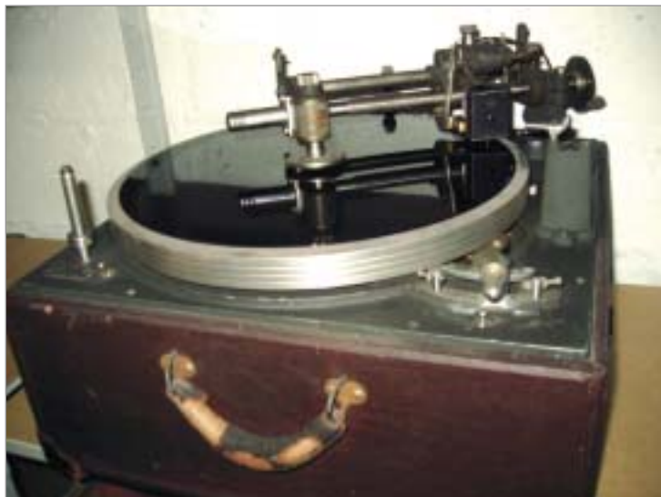
Tot het midden van de jaren 1950 werden belangrijke uitzendingen van het NIR/INR opgenomen op grote 78-toerenplaten. Deze platen werden dus op 1 exemplaar aangemaakt. Op de foto: een graveer-machine die deze platen aanmaakte. (Foto: Omroepmuseum vzw).
